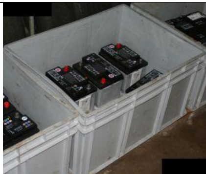
Batteries usagées dans des récipients étanches (par ex. palox)
