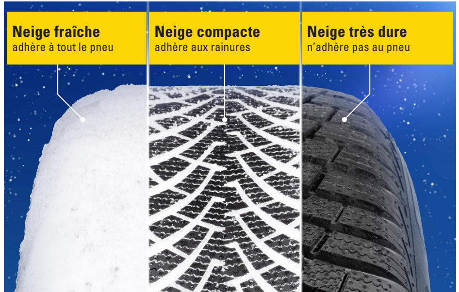
Les pneus d'hiver sont les plus exigeants en ce qui concerne les mélanges de gomme. L'adhérence évolue en fonction du type de neige. En présence de neige fraîche, le pneu doit maintenir le contact avec la chaussée malgré la neige. Photo: Goodyear
