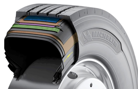
Les pneus de véhicules utilitaires doivent être robustes et durables. Leurs sous-structures (carcasse, ceinture) sont plus sophistiquées et le mélange de gomme est plus dur. Photo: Michelin
